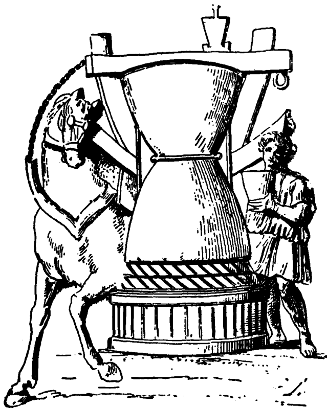
Fig. 9. — Escravo operando um moinho de trigo, segundo um mármore do Vaticano. Consistia em duas pedras ou mós superpostas. A base é formada por uma pedra cilíndrica de 5 pés de diâmetro e de 1 pé de espessura. A mó superior (catillus) se ajustava à superfície cônica da mó inferior (meta). Um eixo mantinha o catillus e regulava o atrito. O escravo despejava o trigo no funil ou parte superior, de onde ele descia para um cone sólido da parte inferior, e a fricção das duas partes do moinho o reduzia a farinha, que um condutor na base recebia à medida que ele fôsse esmagado. Apud Duruy, op. cit. , V, pág. 397.
